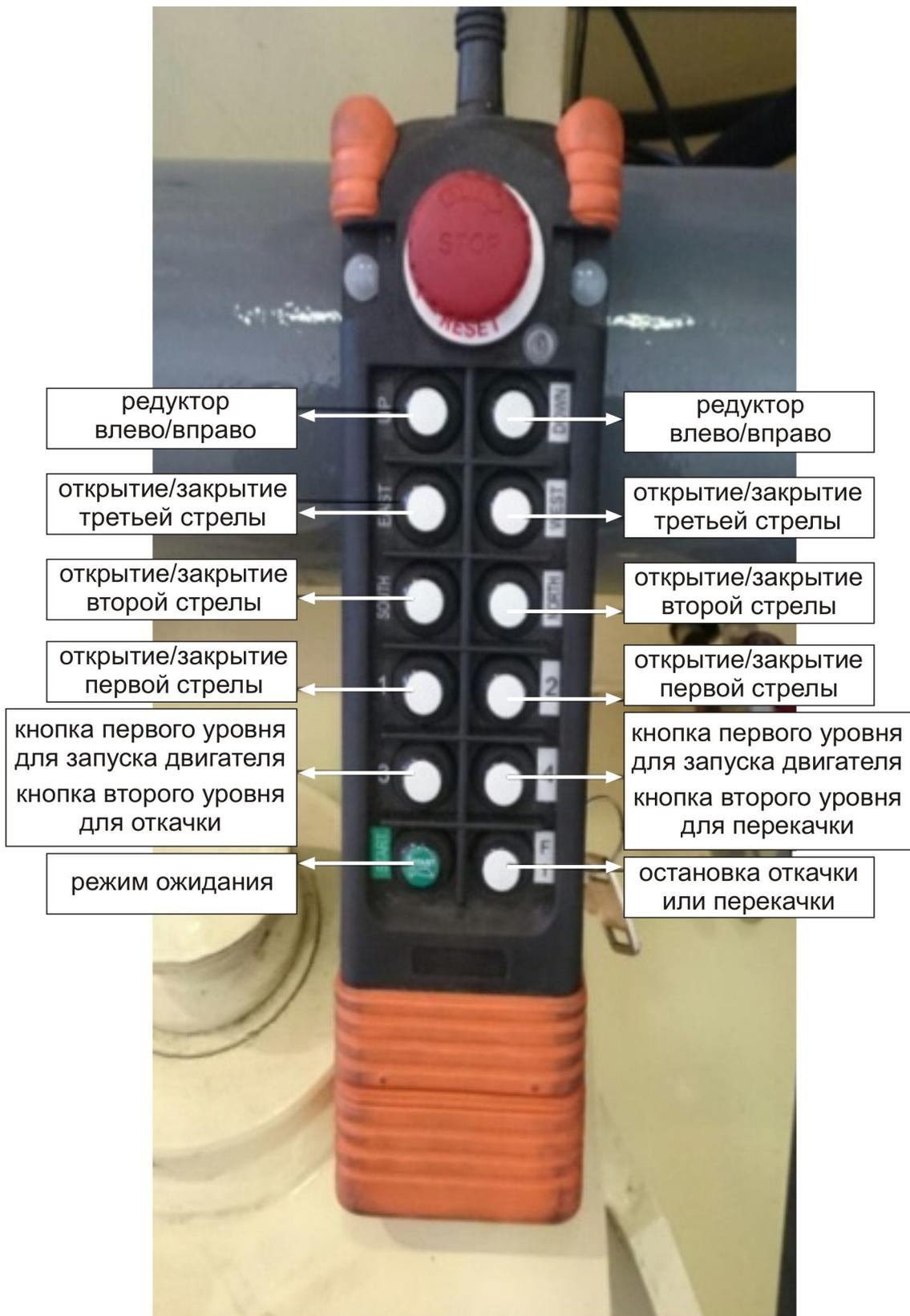
*ЗНАЧЕНИЕ КНОПОК НА ПРИБОРНОЙ ПАНЕЛИ*
